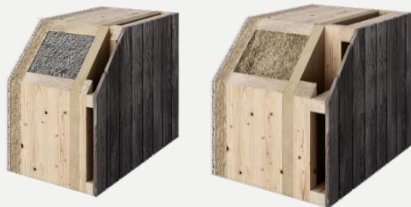
Querschnitt der Außenwanddämmung des Gebäudes Paul. links: EG, rechts: OG.
