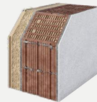
Querschnitt der Außenwanddämmung des Gebäudes Rosa.
